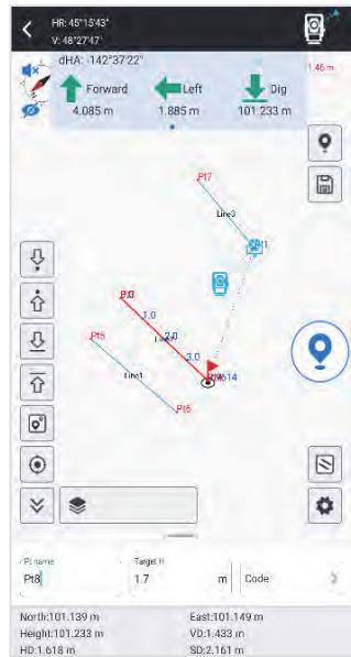
El usuario puede elegir manualmente los puntos de la biblioteca, y el programa formará automáticamente la línea. Luego, el usuario ingresa la distancia del intervalo y los puntos de referencia se calcularán y se mostrarán en la pantalla.
