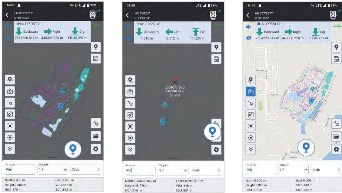
CAD Stakeout le permite importar un mapa base CAD y replantearlo, sin ingresar coordenadas de puntos uno a uno.
