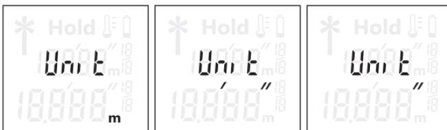
اضغط على زر التشغيل والإيقاف (1). عند ظهور وحدة القياس المرغوبة اترك زر التشغيل والإيقاف (1). بعد ترك الزر يتم تشغيل عددة القياس على وضع الضبط المختار.
