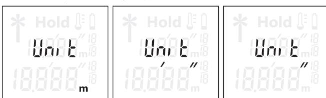
Довго натискайте на вимикач (1). Коли буде відображеня необхідна одиниця вимірювання, відпустіть вимикач (1). Після відпускання вимірювальний інструмент увімкнеться з обраним налаштуванням.
