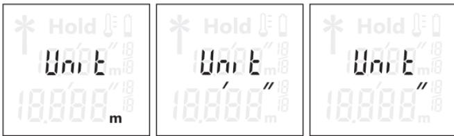
دکمه ی خاموش-روشن (1) را فشار دهید. چنانچه واحد اندازه گیری ظاهر شد، دکمه ی خاموش-روشن (1) را رها کنید. پس از رها کردن، ابزار اندازه گیری با تنظیم انتخاب شده روشن می شود.
